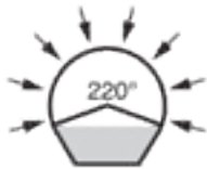
LP Gedeeltelijk geperforeerde drainagebuizen
