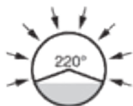
LP Gedeeltelijk geperforeerde drainagebuizen
