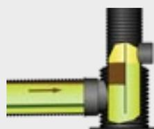
Grâce à la légère inclinaison du tuyau, les liquides légers qui remontent lors du trajet de sédimentation terminent dans le regard d'arrivée où elles sont collectées dans le tube de récupération immergé.
