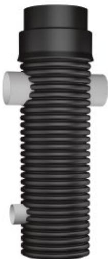
Système en PP DN 600 léger et durable, noir à l'extérieur, jaune à l'intérieur pour une inspection optimale. Conçu pour des tampons standard CW 610 à livraison à la charge du client. Diamètre d'arrivée point bas DN 200, diamètre de sortie point haut DN 315, en fonction des besoins, réduction à la charge du client. Bypass DN 315 KG intégré. Le regard est curable sous haute pression.
