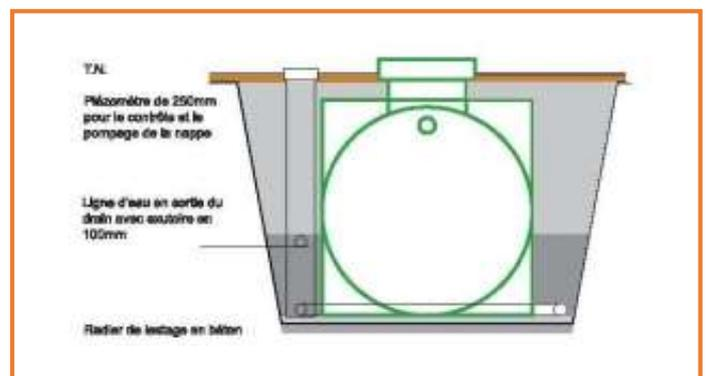
Figure 3 : contrôle du niveau de la nappe avec un piézomètre
