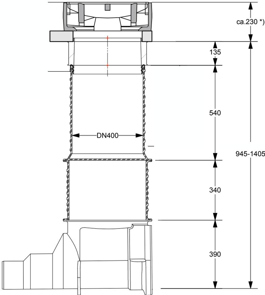
PE kolk in lijn van de afvoerleiding
