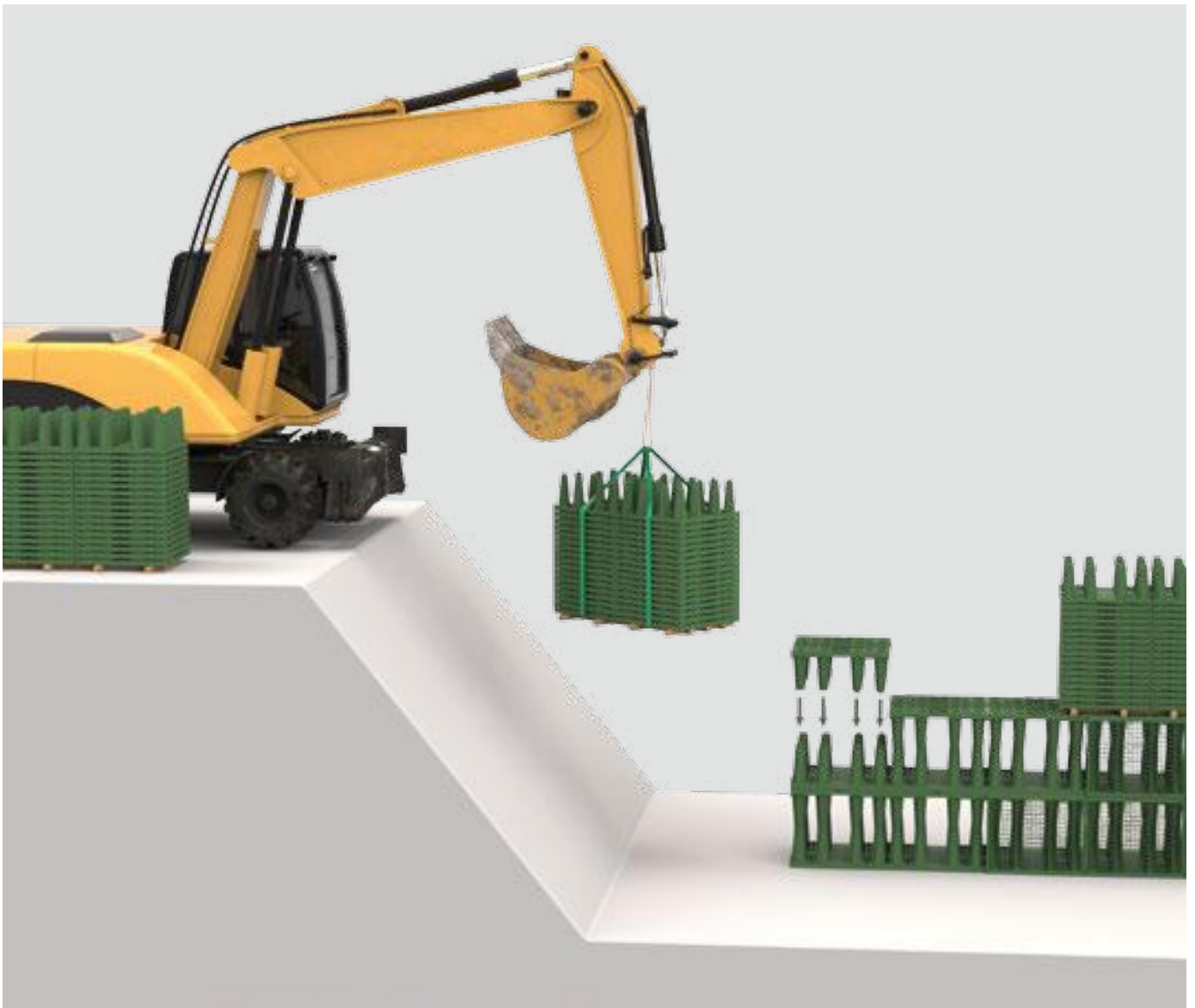
Montage in de bouwput
