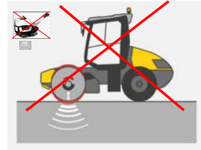
Werfverkeer en compactering met trillingen is verboden op de goot
