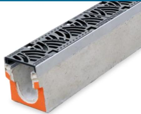
**Caniveau hydraulique résistance intégrée en béton armé avec profil en acier galvanisé discret et grille esthétique 'VIBRATION' en fonte ductile – classe D 400.**
