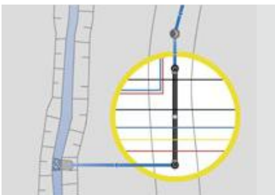
SediPipe XL, geïntegreerd in een bestaand hemelwaterriool
