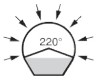
LP Gedeeltelijk geperforeerde drainagebuizen
